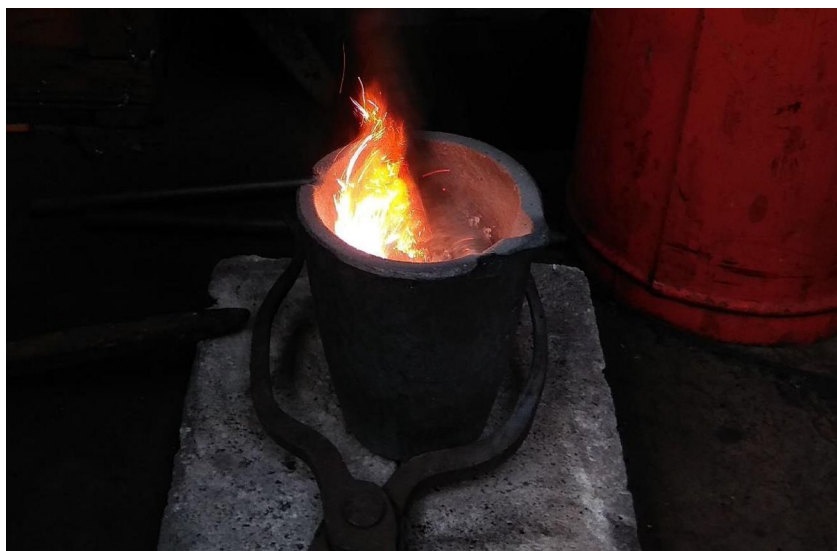
Obr. 1. Reakce taveniny při přidání hydridu titanu ( \text{TiH}_2 )
