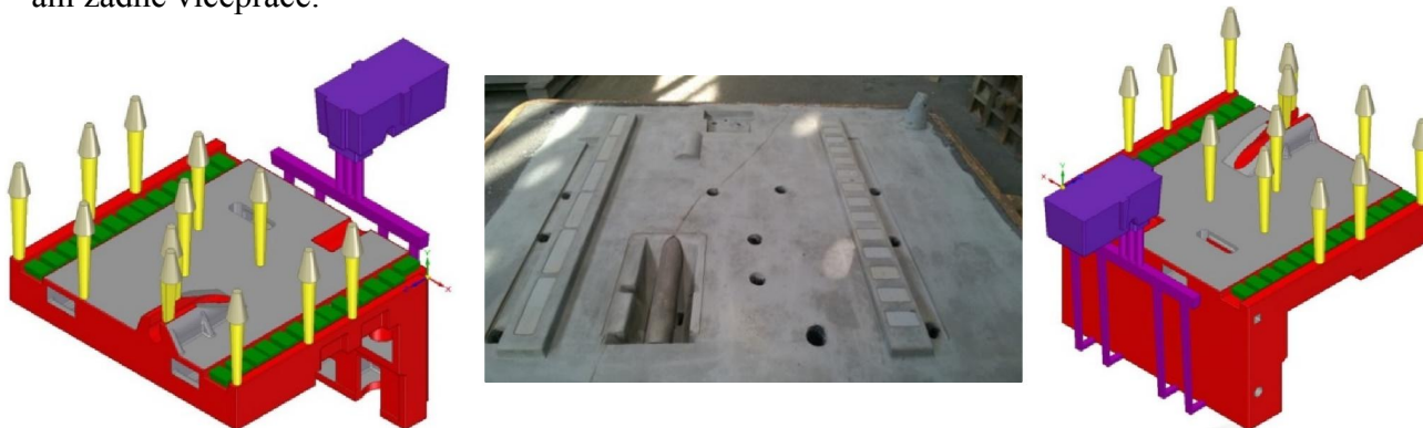
Obr. 5. Původní technologie Vřeteníku WHR 13, rozmístění chladítek (zeleně) a výfuků (žlutě), uprostřed foto již zaformovaných chladítek a výfuků ve vršku formy
