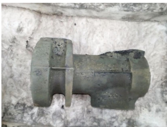
Obr. 8. Těleso čerpadla ve vyžíhaném stavu
