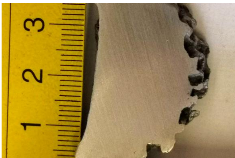
Obr. 4. Řez vzorkem odlévaného do soli pomocí prostého lití a spečení soli
