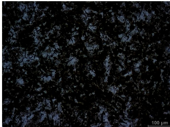
Obr. 21. mat. AGI EN-GJL jádro vzorku po laserovém povrchovém kalení
