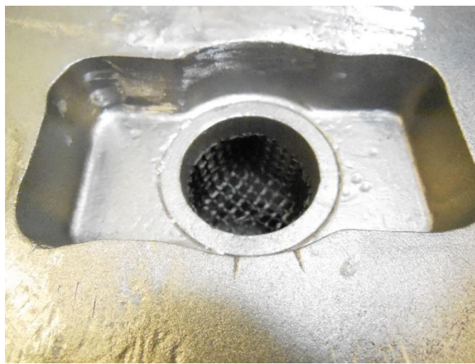
Obr. 4. Tkaninové sítko ve vtokové vložce
