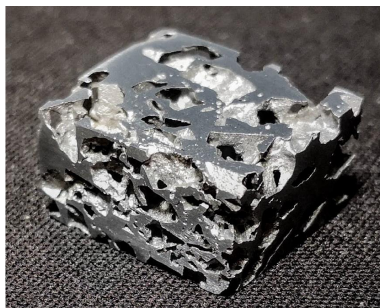
Obr. 7. Nejlepší z vyhotovených vzorků vyrobený litím na sůl za působení zvýšeného tlaku při tuhnutí
