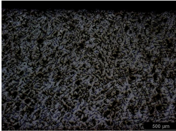
Obr. 18. Mat. AGI EN-GJL250, indukčně kalený povrch
