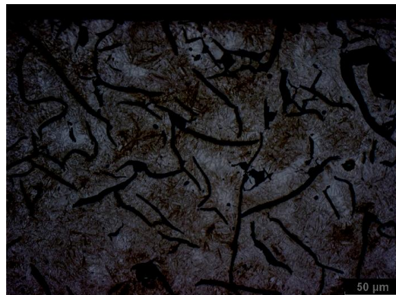
Obr. 16. Mat. AGI EN- GJL250 detail povrchové vrstvy
