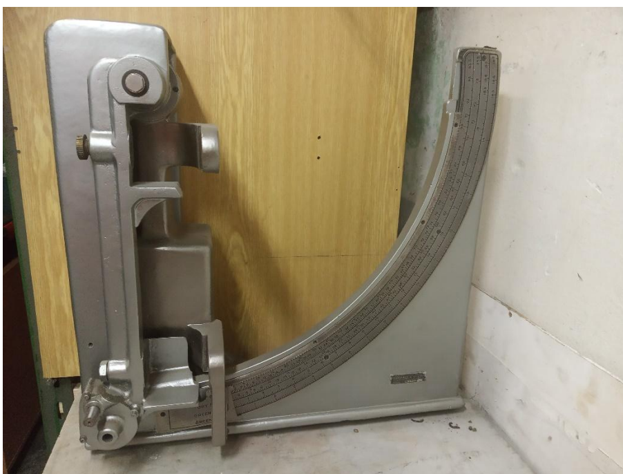
Obr. 1. Pevnostní přístroj DIETERT využívající gravitace
