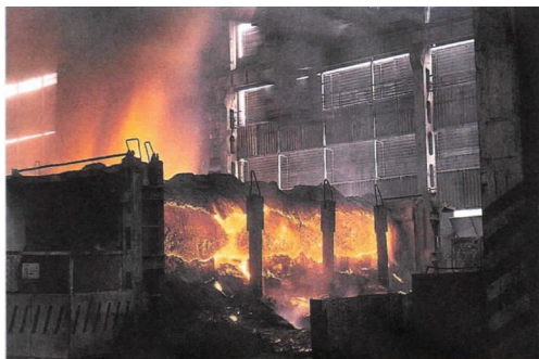
Obr. 2. Pohled na Achesonovu pec během syntézy[37]
