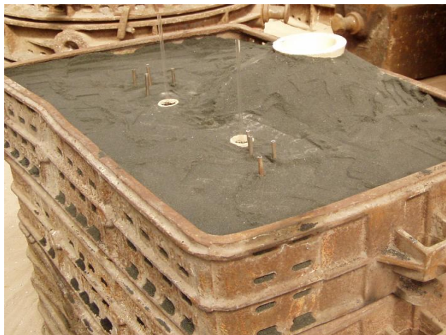
Obr. 1. Forma odlitku krychle o hraně 400mm s přípravou pro termočlánky
