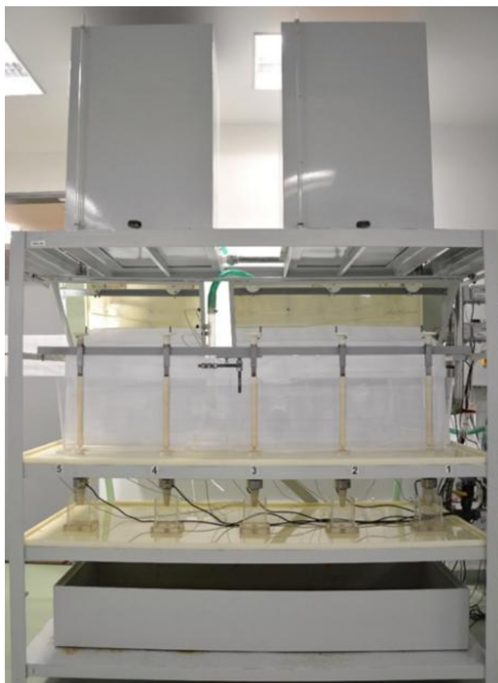
Obr. 1. Sestava fyzikálního modelu pět proudé mezipánve s příslušenstvím
