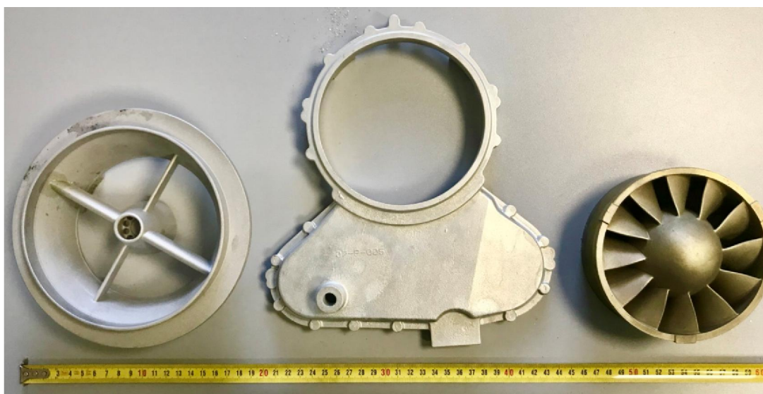
Obr. 5. Příklady experimentálních odlitků vyrobených přesným litím metodou vytavitelného modelu ve společnosti ALUCAST v rámci probíhajícího projektu MPO TRIO FV30305
