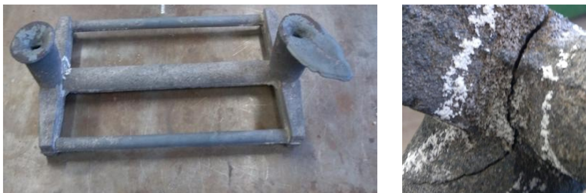
Obr. 10. Zkušební těleso trhlinami mimo měřitelnou oblast pod náličky
