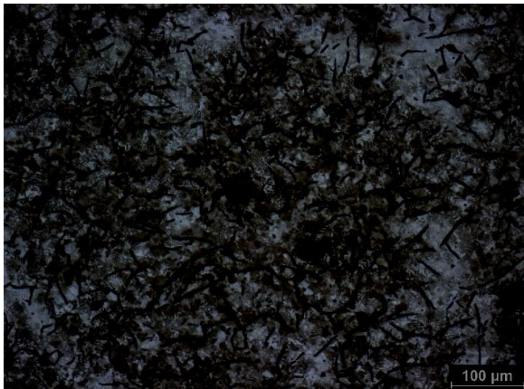
Obr. 20. mat. AGI EN-GJL250, jádro vzorku po indukčním povrchovém kalení
