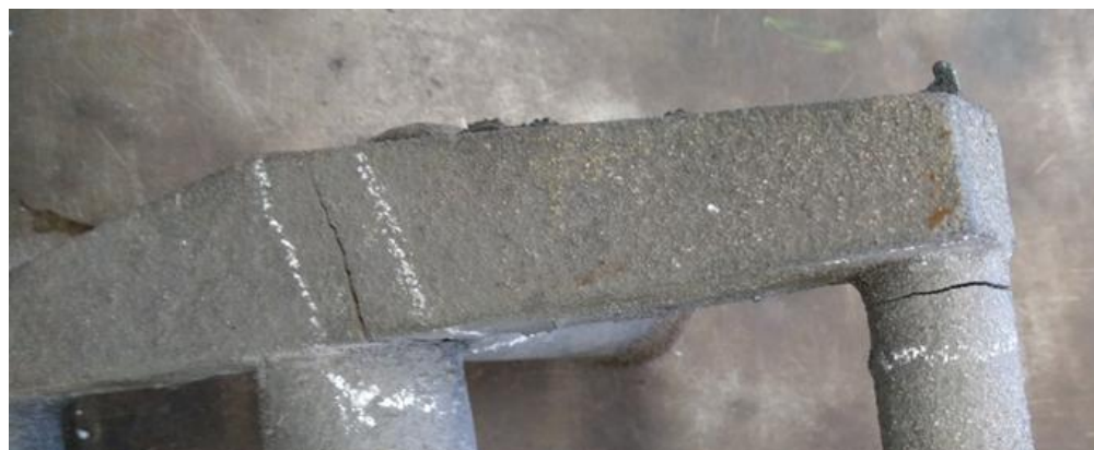
Obr. 11. Praskliny-trhliny mimo měřitelnou oblast standardního zkušebního tělesa
