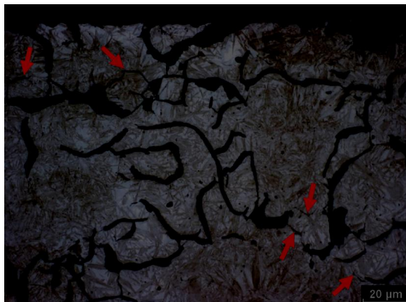
Obr. 17. Mat. AGI GJL 250, povrchové trhliny po laserovém povrchovém kalení
