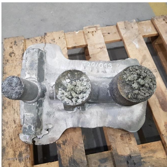
Obr. 6. Odlitek s vtokovou soustavou a nálitky
