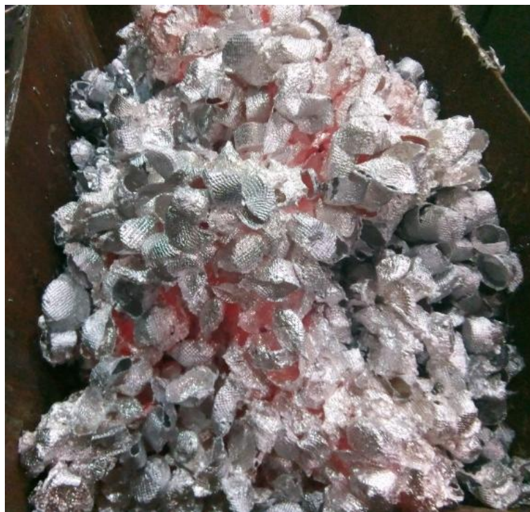
Obr. 5. Zbytky vtoků s tkaninovými sítky – po vytavení
